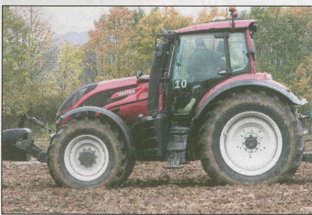
Her er den rigtige topmodel i Valtras nye T-serie. T235 har en sekscylindret motor med 235 hk og kan med boost yde op til 250 hk. (Foto: Bøje Østerlund)
